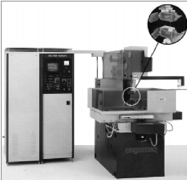
O corte a fio é programado por computador, que permite o corte de perfis complexos e com exatidão.
