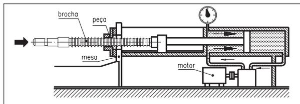
**Brochadeira horizontal** – Apresenta a vantagem de possibilitar o trabalho com ferramentas de grande comprimento. É bastante utilizada na indústria mecânica.
