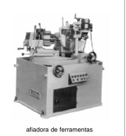
Às vezes, é necessário afiar ferramentas de corte com três tipos de operações: desbaste, semi-acabamento e acabamento, utilizando-se rebolos diferentes em cada operação.
