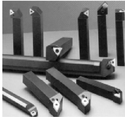
O carboneto de tungstênio dissolve-se facilmente em cobalto (Co), o qual é adicionado à mistura, atuando como metal ligante. O resultado final combina as propriedades da partícula dura (resistência ao desgaste) com as propriedades do metal ligante (tenacidade).
