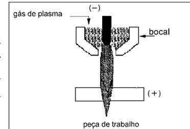
Essa técnica de corte foi introduzida na indústria em 1957 e, inicialmente, era usada para cortar qualquer metal a altas velocidades de corte. As chapas a serem cortadas variavam de 0,5 mm até 250 mm.
