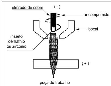
A principal desvantagem desse processo de corte é a rápida erosão do eletrodo. Um eletrodo de tungstênio, por exemplo, desgasta-se em poucos segundos se o gás de corte contiver oxigênio. Por isso, é necessária a utilização de eletrodos especiais feitos de zircônio, háfnio ou ligas de háfnio. Mesmo com o emprego de eletrodos especiais, a vida útil deles é bem menor que a dos eletrodos do processo de plasma convencional.
